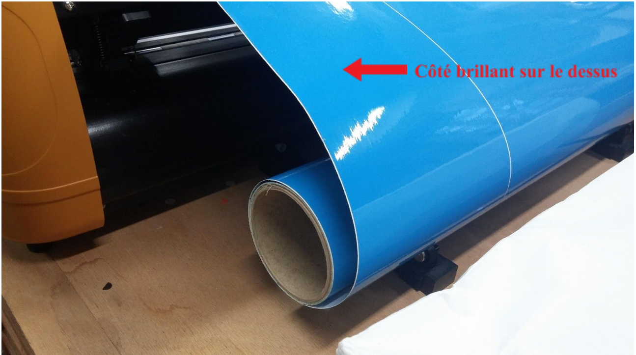
Rouleau sur support (remarque : notez le sens de déroulement)
